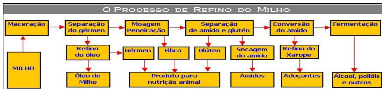
Figura 1 – Processo de industrialização do milho, via úmida (Fonte: Abimilho, 2006 )
