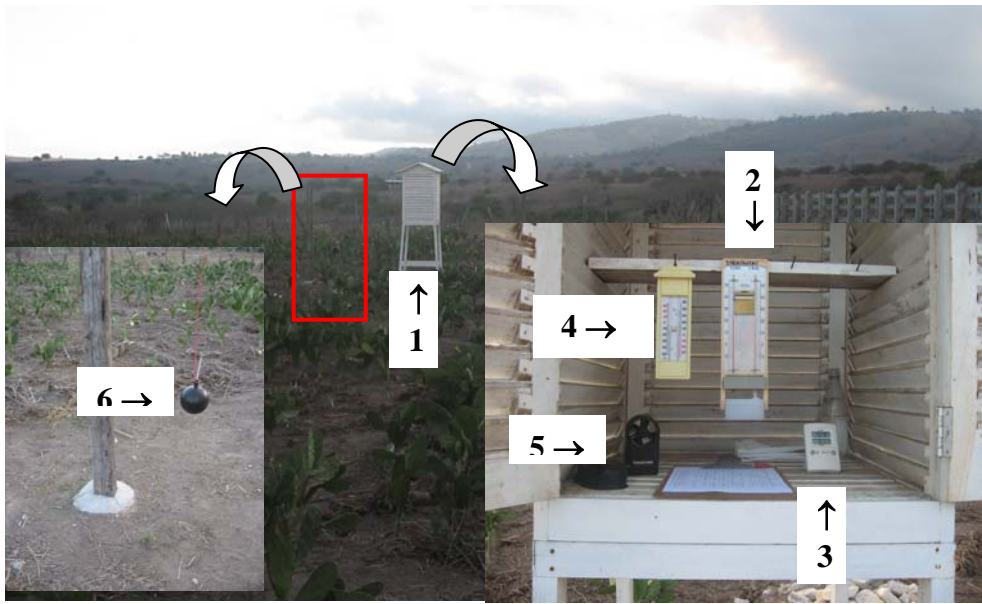
Figura 3 - Estação meteorológica instalada ao lado do piquete experimental, observa-se no abrigo termométrico (1) o psicrômetro (2), o termoigrômetro digital (3), o termômetro de extrema (4) e o anenômetro digital portátil (5), e ao lado do abrigo o globotermômetro (6).
