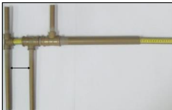
Figura 4. Hipômetro, equipamento utilizado para aferir medidas (LP, AC, AG, LG, LoG e CC)
