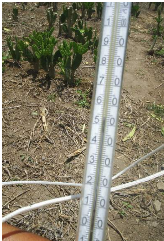
Figura 4 - Termômetro de globo negro marcando 54°C às 13 h no dia 24/01/2008.
